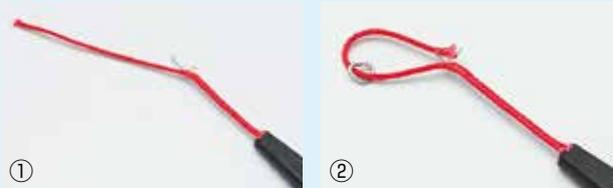
① 中芯を抜いたブレイドラインに、ブレイドノッターを通し、およそ真ん中辺りから抜きます。カバー部分がすべて出るまで突き出してください。
